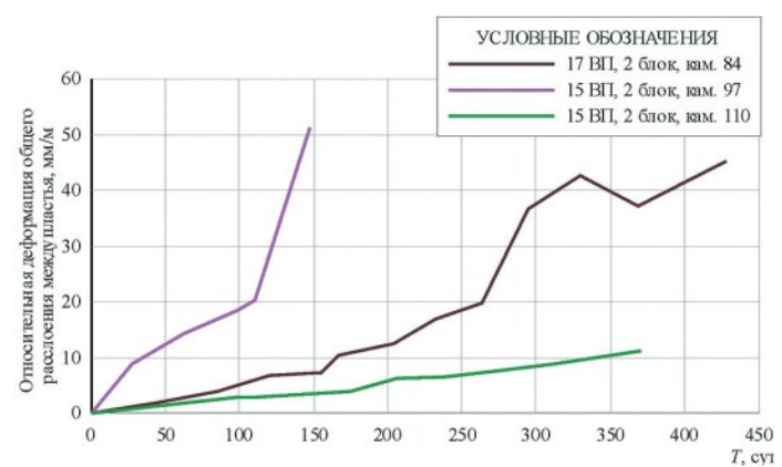
Рис. 4. Графики относительной деформации массива междупластья на станциях, установленных на шахтном поле БКПРУ-2: 17 ВП 2 блок, кам. 84; 15 ВП, 2 блок кам. 97; 15 ВП, 2 блок кам. 110
